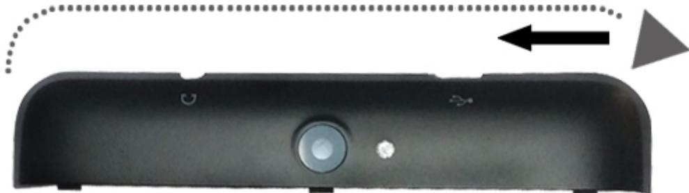
2. Снимите крышку, слегка надавив на неё в направлении вверх.
