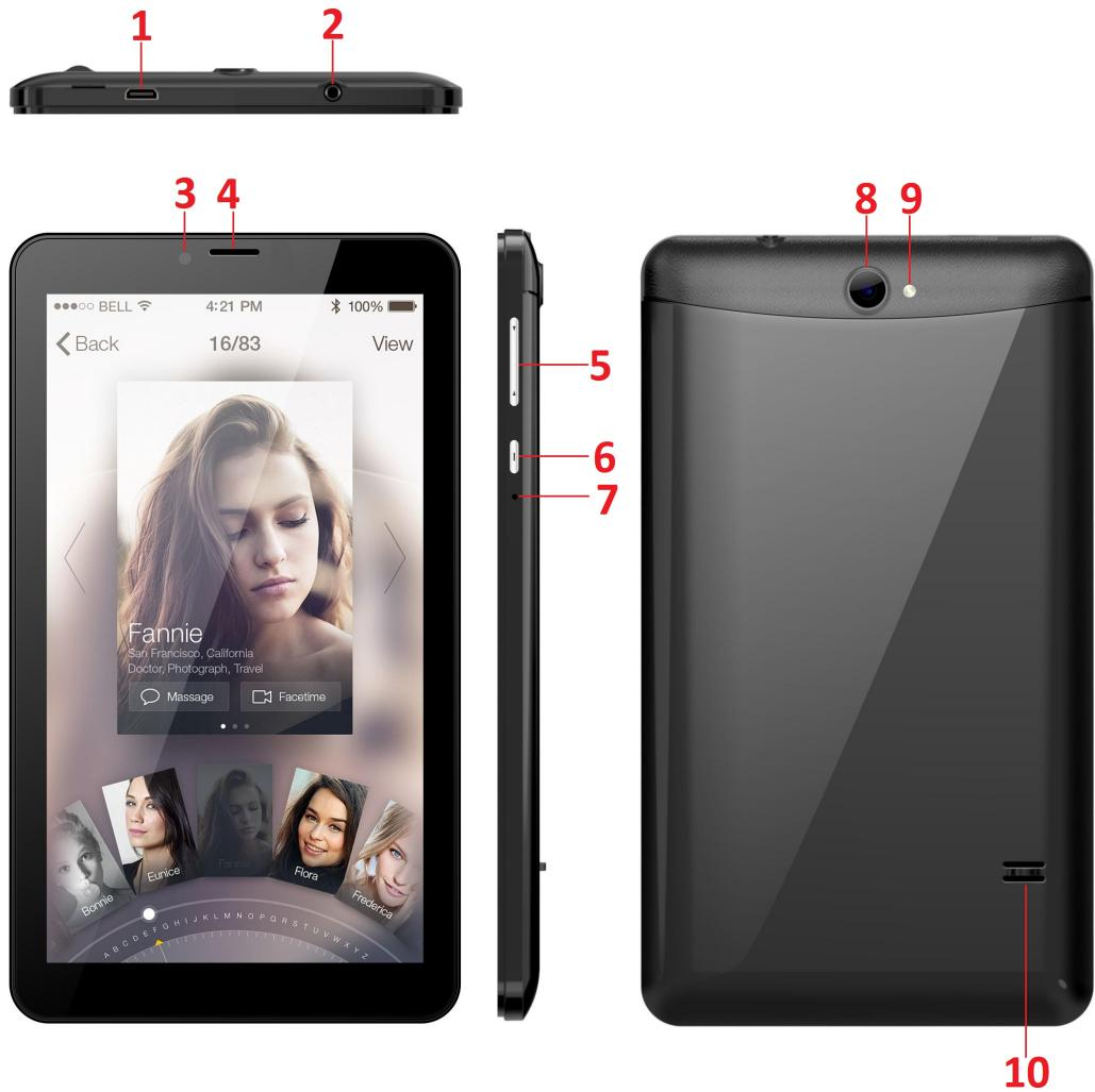
1. Micro USB-разъём (для зарядки и синхронизации с ПК)
