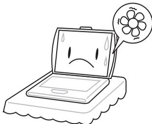
Во избежание перегрева компьютера, не блокируйте вентиляционные отверстия на корпусе.
