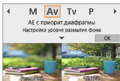
Размытый фон (С меньшим диафрагменным числом: f/5.6 )
