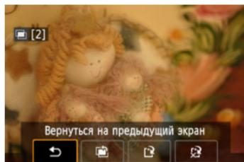
Для просмотра изображения с мультиэкспозицией на текущий момент, проверки экспозиции и просмотра объединения изображений до завершения съемки указанного числа экспозиций можно нажать кнопку < ▶> (если задано значение [Вкл:Функ/упр], но не значение [Вкл:Сер.съём]).
