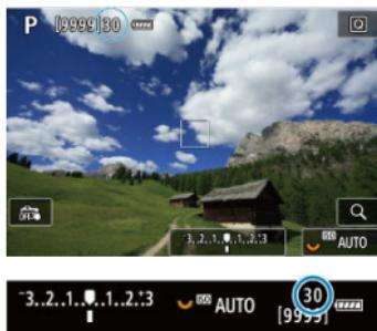
Соответствующая максимальная длина серии отображается в левом верхнем углу экрана съемки и в правом нижнем углу видоискателя.
