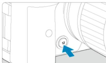
Нажав кнопку предварительного просмотра глубины резкости, можно привести величину диафрагмы объектива в соответствие с текущей установкой и проверить область, находящуюся в фокусе (глубину резкости).
