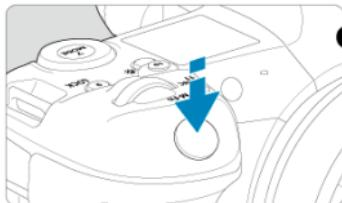
Этим нажатием активизируется функция автофокусировки и система автоэкспозиции, которая устанавливает выдержку и величину диафрагмы. Величина экспозиции (выдержка и величина диафрагмы) отображается на экране, в видоискателе и на ЖК-дисплее в течение прибл. 8 с (таймер замера/ $\star$ 8).
