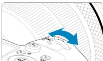
Поворачивайте диск <
