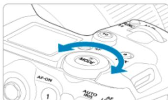
Поворачивайте диск <
