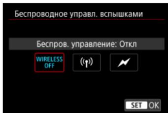
Можно использовать беспроводную радиопередачу или оптическую передачу для беспроводной съемки с несколькими вспышками.
