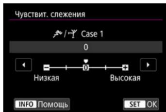
Настройка чувствительности отслеживания объектов в режиме Servo AF при перемещении препятствий через точки AF или при выходе объектов из точек AF.
