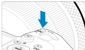
Нажав кнопку < M-Fn > и поворачивая диск < ○ >, можно задать чувствительность ISO (❸), режим работы затвора (❹), режим AF (❺), баланс белого (❻) и компенсацию экспозиции при съемке со вспышкой (❾).
