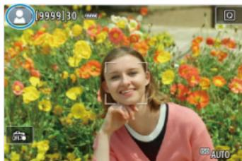
Камера определяет тип сцены и автоматически задает настройки в соответствии со сценой. Распознанный тип сцены отображается в левой верхней части экрана. Сведения о значках см. в разделе [Значки сюжетов](#).
