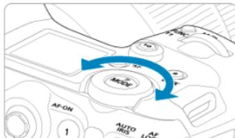
Нажмите кнопку, например <**MENU**>, затем поворачивайте диск <
