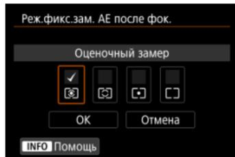
Для каждого режима замера можно указать, требуется ли фиксировать экспозицию (Фиксация AE) после завершения фокусировки на объекты в режиме покадрового AF. Экспозиция остается фиксированной, пока кнопка спуска затвора удерживается наполовину нажатой. Выберите режимы замера экспозиции для фиксации AE и установите флагшки [✓]. Выберите [OK] для регистрации настройки.
