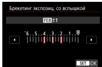
Вспышки Speedlite с функцией брекетинга экспозиции со вспышкой (FEB) могут автоматически изменять мощность вспышки при съемке трех кадров подряд.
