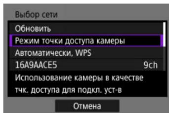
Режим точки доступа камеры предназначен для подключения камеры по Wi-Fi непосредственно к каждому устройству. Отображается при выборе [Wi-Fi], [Bluetooth] или [Wi-Fi+Bluetooth] после [(?)]: **Подключение Wi-Fi/Bluetooth**.
