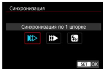
Обычно для этого параметра задается значение [**Синхронизация по 1 шторке**], чтобы вспышка срабатывала сразу после начала съемки.
