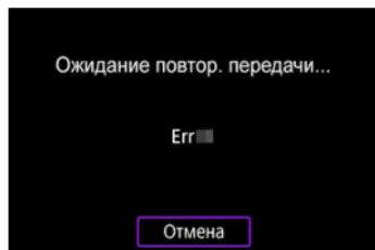
После устранения проблемы изображения, которые изначально было невозможно передать, будут переданы автоматически. Если включена эта функция, повторная попытка передачи производится автоматически независимо от того, используется ли автоматическая передача или снятые изображения передаются вручную по FTP. Обратите внимание, что при отмене передачи или выключении питания камеры автоматическая повторная передача не производится.
