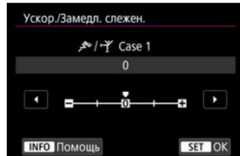
Настройка чувствительности отслеживания объектов в режиме AI Servo AF/Servo AF в случае внезапных значительных изменений их скорости, а также в случае внезапного начала движения или остановки объектов.
