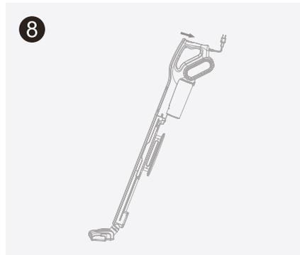
8. После использования пылесоса сдвиньте переключатель ON/OFF («ВКЛ./ВЫКЛ.») назад, чтобы выключить пылесос, а затем отсоедините его силовой кабель от розетки.
