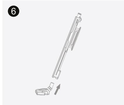
6. Совместите щетку с контактной поверхностью соединительной трубки и медленно вставьте ее.
