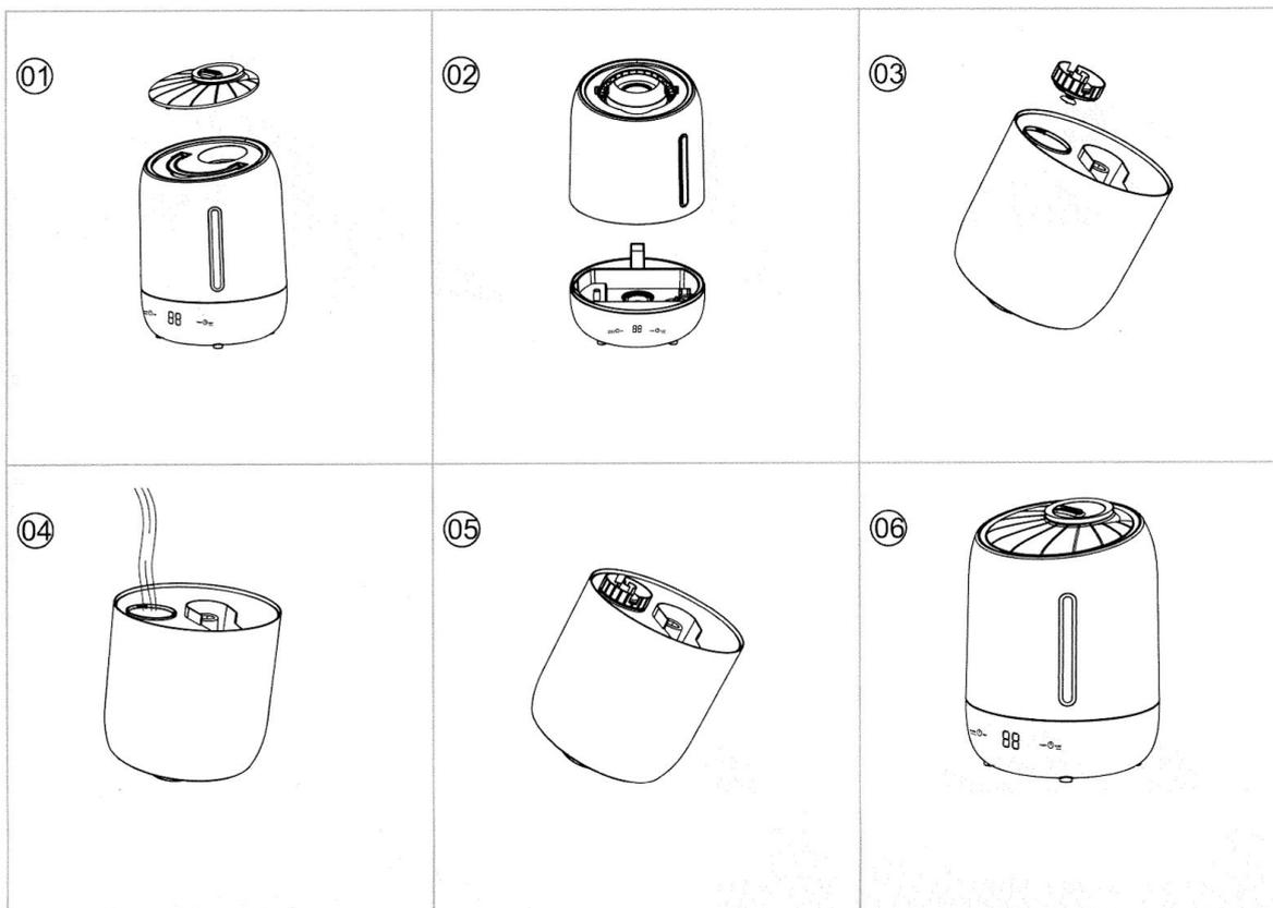
1. Снимите крышку с соплом.
