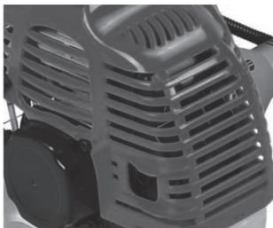
Вентиляционные отверстия на корпусе двигателя, а также ребра охлаждения цилиндра во время работы могут забиваться сухой травой. Это может привести к перегреву двигателя. Поэтому периодически прочищайте вентиляционные отверстия и ребра охлаждения цилиндра кисточкой или сжатым воздухом.
