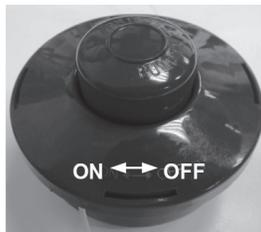
Совместите выступ корпуса катушки с пазом в крышке катушке. Нажмите на крышку катушки и не отпуская поверните ее в направлении «OFF».
