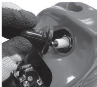
Снимите со свечи наконечник высоковольтного провода.
