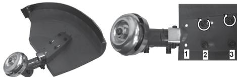
Установите на болты кожух. Кожух имеет три пары отверстий. Устанавливайте кожух через отверстия 2 и 3, чтобы он был ближе к триммерной головке. Зафиксируйте кожух, закрутив четыре гайки.
