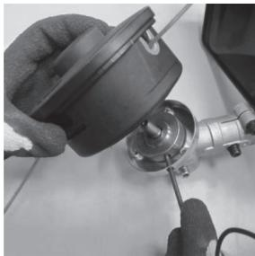
Совместите отверстия на защитном кожухе и защитном фланце триммерной головки. Вставьте шестигранный ключ в отверстие кожуха, заблокировав вал и накрутите катушку на вал триммерной головки.
