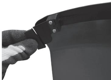
Снимите с ножа защитного кожуха чехол. Данный нож обрезает излишек лески при ее полуавтоматической подаче.
