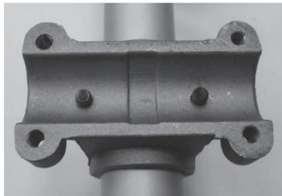
Снимите верхнюю половину крепления рукоятки к штанге.
