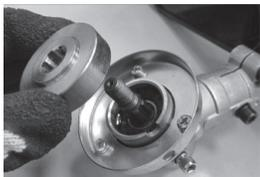
Установите защитный фланец на триммерную головку.
