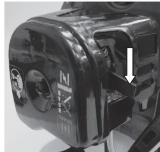
Установите рычаг воздушной заслонки в положение «горячий» (↓). И продолжайте запуск двигателя за ручку стартера.
