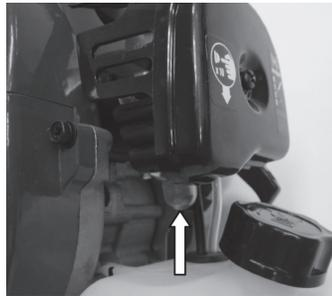
Нажмите 5-7 раз на кнопку праймера для заполнения карбюратора топливной смесью.
