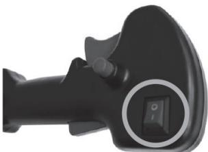
На ручке управления установите выключатель зажигания в положение «I».
