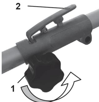
Соедините две половины штанги. Для этого ослабьте винт-барашек (поз. 1) крепления соединительной муфты, нажмите на фиксатор (поз. 2) и вставьте нижнюю половину штанги в соединительную муфту. Отпустите фиксатор. Фиксатор должен попасть в отверстие на нижней штанге и зафиксировать ее. Затяните винт-барашек.
