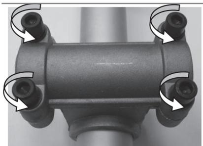
С помощью шестигранного ключа открутите 4 винта крепления рукоятки управления к штанге.
