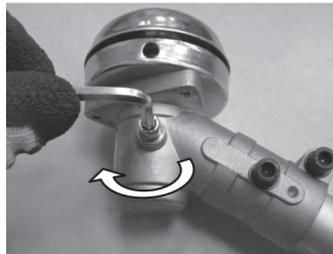
Шестигранным ключом закрутите болт редуктора. Не прилагайте большое усилие при закручивании болта т.к. корпус редуктора сделан из алюминия и при сильном усилии затягивания резьба на корпусе редуктора может срезаться.
