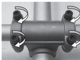
Прижмите части рукоятки управления верхней половиной крепления и закрутите 4 винта. Для регулировки наклона рукояток ослабьте винты, установите положение рукояток, закрутите винты.
