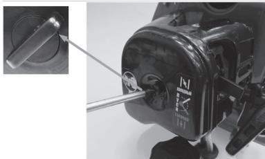
Отверните винт крепления крышки воздушного фильтра с помощью отвертки или руками (в зависимости от модели триммера)
