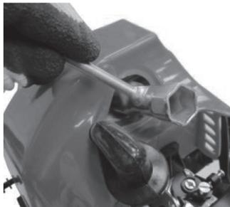
Комбинированным ключом открутите свечу зажигания против часовой стрелки.
