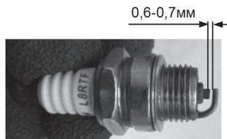
Очистите электроды свечи зажигания металлической щеткой. Проверьте зазор между электродами. Он должен составлять 0,6-0,7мм.
