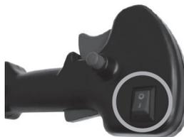
Установите выключатель зажигания в положение «0».
