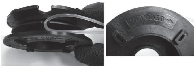
Возьмите отрезок лески длиной примерно 5м, сложите его пополам. Вставьте петлю лески в паз посередине шпули. Намотайте леску на шпулю в два ручья. Направление намотки лески указано стрелкой на корпусе шпули.
