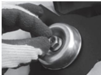
Закрутите от руки гайку. Внимание! Гайка имеет левую резьбу (закручивается против часовой стрелки)
