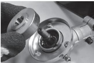
Установите защитный фланец на триммерную головку.
