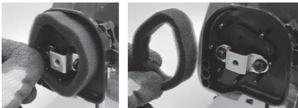
Снимите крышку воздушного фильтра и извлеките из корпуса воздушного фильтра фильтрующий элемент (поролоновую губку).
