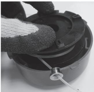
Установите шпулю в корпус катушки, предварительно заправив концы лески в выходные отверстия на корпусе катушки.
