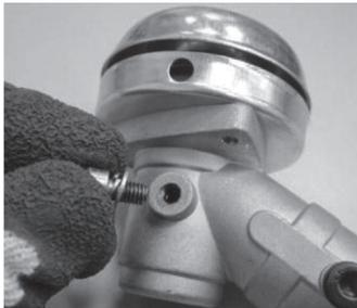
Проверьте через отверстие наличие смазки в редукторе. Если необходимо добавьте с помощью шприца смазку в редуктор.
