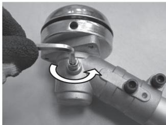
Шестигранным ключом открутите против часовой стрелки болт редуктора.
