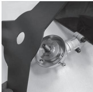
Установите на защитный фланец режущий нож.
