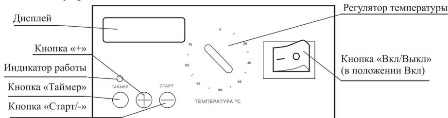
На панели управления расположены дисплей, кнопка «Вкл/Выкл», кнопка запуска процесса сушки, кнопки настройки времени таймера и регулятор температуры.
