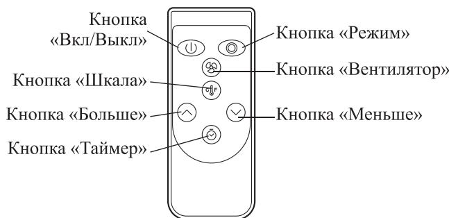
Все кнопки на панели управления сенсорные. Нажатие на кнопки панели управления сопровождается звуковым сигналом. Вы можете управлять работой обогревателя с помощью пульта ДУ. Все кнопки панели управления дублируются на пульте ДУ. Пульт ДУ питается от 1 батарейки CR2032 (входит в комплект). Пульт ДУ работает на расстоянии не более 5 м от устройства. При этом нужно направлять пульт строго на инфракрасный датчик (**ИК-датчик**) на панели управления.
