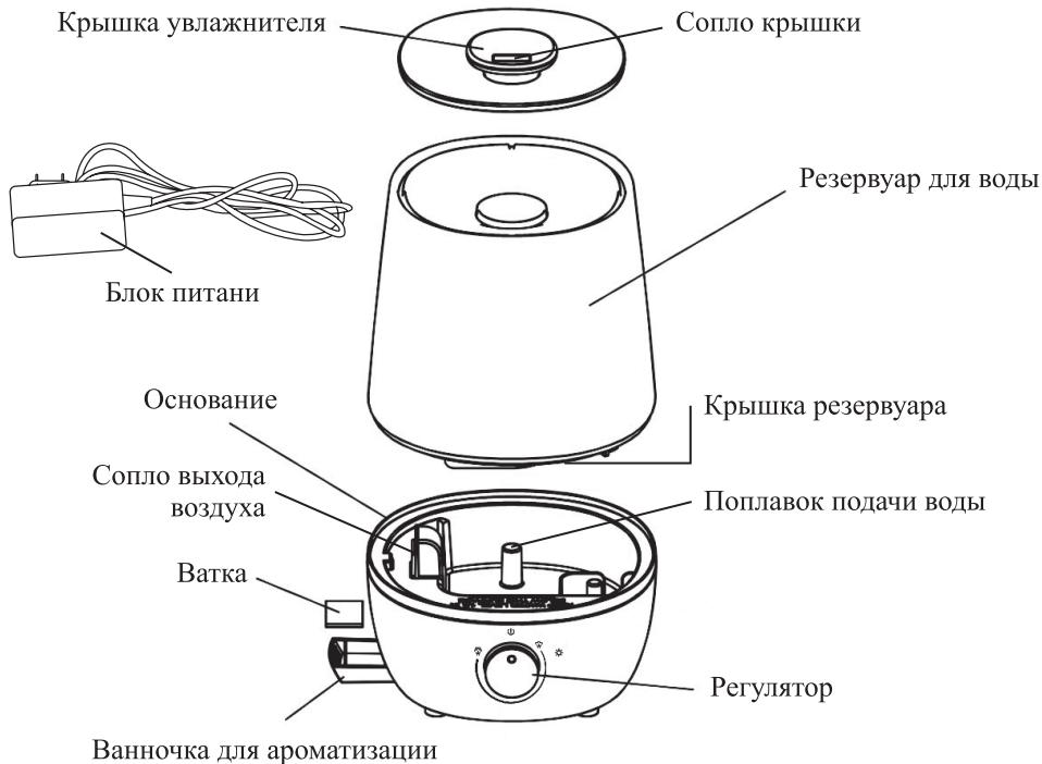
Включается увлажнитель при помощи регулятора: при повороте по часовой стрелке раздается щелчок — значит, увлажнитель включен, при этом загорится индикатор регулятора. Поворачивая регулятор по часовой стрелке, регулируйте степень потока тумана.
