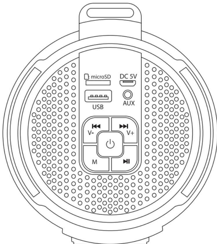
**DC 5V** - Разъем для подключения провода питания.
