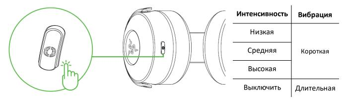
Когда гарнитура включена, Razer HyperSense также работает на аналоговом разъеме 3,5 мм. Обратите внимание, что звуковые сигналы доступны только при беспроводном подключении. По умолчанию эта функция включена и установлена на Среднюю интенсивность.
