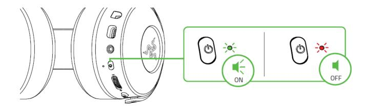
Когда гарнитура работает и подключена к вашему устройству, доступны другие функции кнопки питания. Работа этих функций зависит от текущего состояния вашего устройства.
