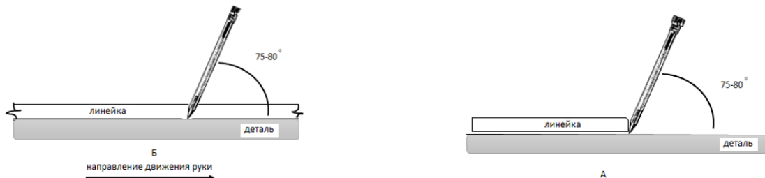
Рис.2. Нанесение линий: а — наклон твердосплавного карандаша в сторону от линейки; б — по направлению перемещения твердосплавного карандаша.
