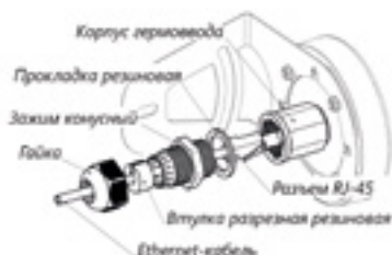
Рис. 2. Подключение Ethernet-кабеля к внешнему блоку
