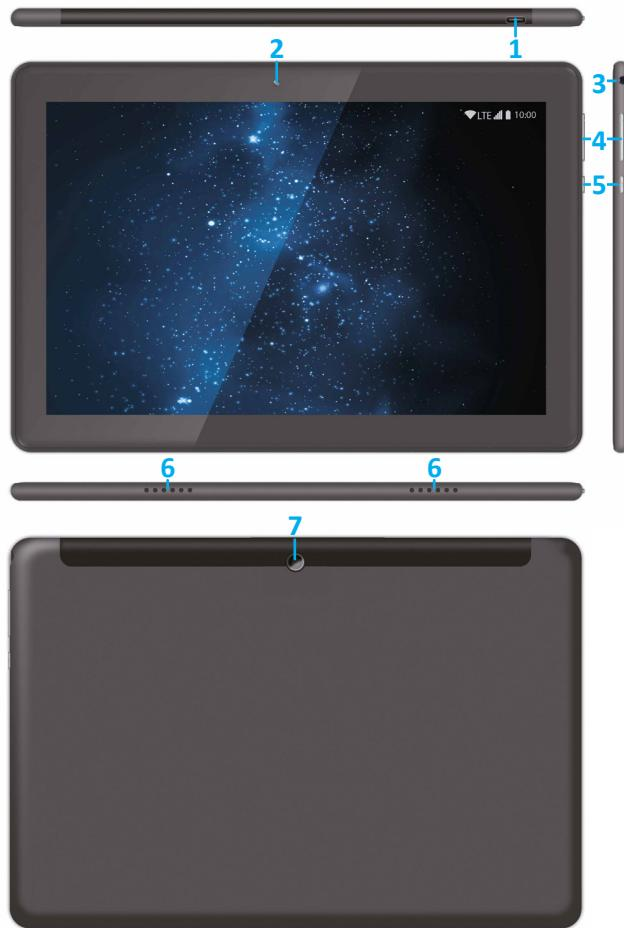
1. Разъём USB Type-C (для зарядки и синхронизации с ПК).
