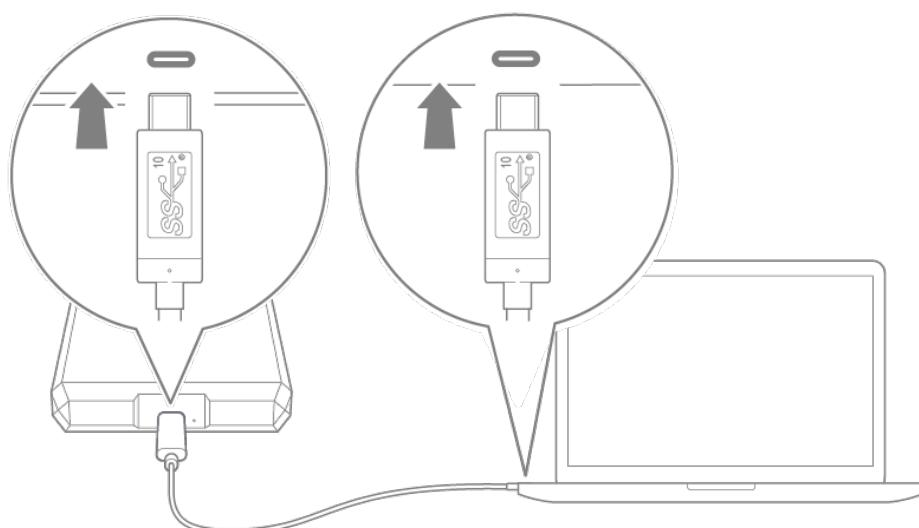
USB-C-на-USB-A (USB 3.0/USB 2.0): используйте этот кабель, если на компьютере отсутствует порт USB-C.
