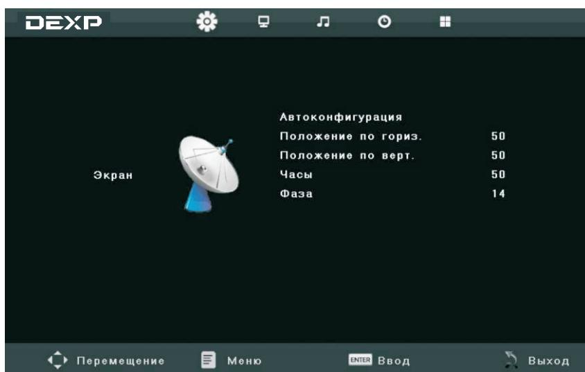
Примечание: Экранное меню доступно в режиме ПК. Эти функции устанавливаются для настройки экрана ПК. Нажмите на  $\nabla/\Delta$ , чтобы выделить одну из следующих опций, затем нажмите на ENTER или  $\triangleright$  чтобы выбрать ее.
