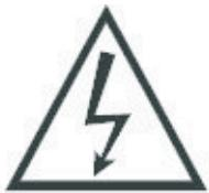
Символ молнии со стрелкой в равностороннем треугольнике предупреждает пользователя о наличии неизолированного опасного напряжения в корпусе устройства, величина которого представляет риск удара электрическим током для пользователей.
