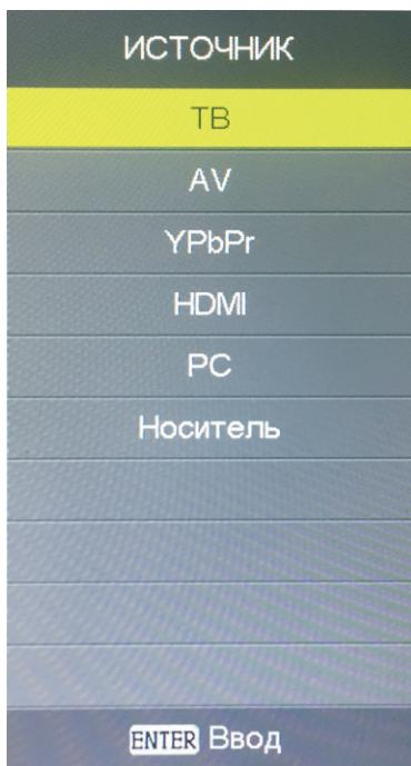
Нажмите кнопку **SOURCE** на пульте дистанционного управления, чтобы отобразить на экране ТВ список источников входа.
