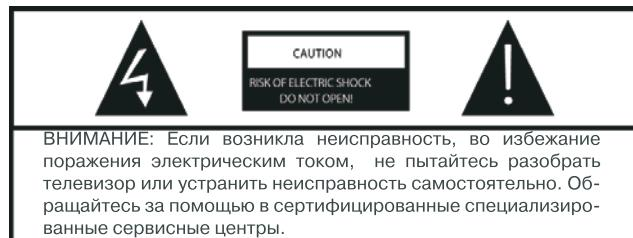
**При самостоятельной модификации или ремонте LED телевизора возможно поражение электрическим током. Не пытайтесь вскрывать телевизор и осуществлять техобслуживание или ремонт, обратитесь для этого в сервисный центр.**
