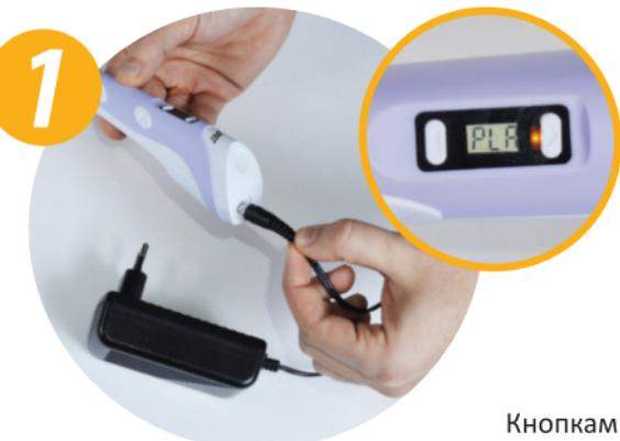
Возмите адаптер питания и подключите его к устройству, а затем подключите к сети. Загорится желтый индикатор, и надпись на ЖК-дисплее «PLA».
