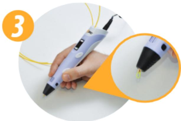
Вставьте заранее подготовленный кусок пластика в отверстие для загрузки пластика (перед загрузкой пластика убедитесь, что его концы ровно обрезаны). Другой рукой нажмите кнопку «Подача пластика» и держите её до тех пор, пока из сопла не появится расплавленный пластик. Так как разные цвета пластика имеют разную температуру плавления, может потребоваться ручная настройка температуры для этого см. пункт РЕГУЛИРОВКА ТЕМПЕРАТУРЫ.
