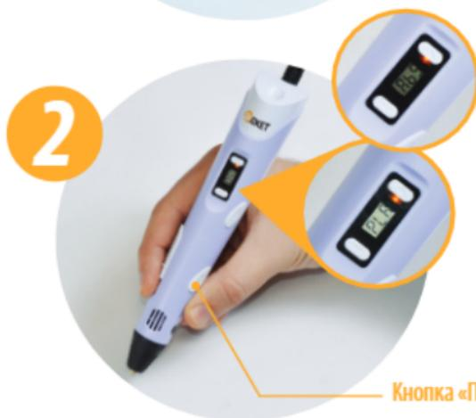
Кнопками регулировки температуры выберите материал, с которым Вы собираетесь работать «PLA» или «ABS». Далее нажмите кнопку подачи пластика, и ручка автоматически начнет прогрев до необходимой температуры для выбранного вида пластика. Во время прогрева будут гореть красный и желтый индикаторы, на ЖК-дисплее Вы увидите, как идет прогрев устройства\*. Красный индикатор изменится на зеленый, это означает, что устройство готово к использованию.
