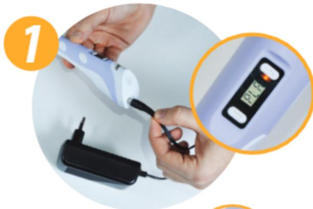
Возьмите адаптер питания и подключите его к устройству, а затем подключите к сети. Загорится желтый индикатор, и надпись на ЖК-дисплее «PLA».
