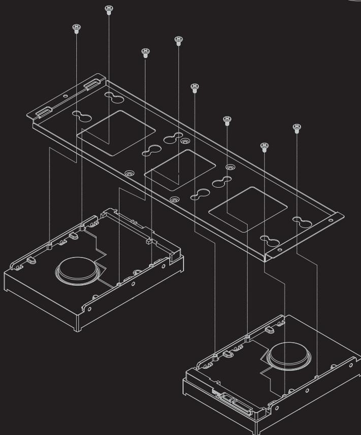
Установите жёсткие диски HDD на крепление и закрепите винтами для жёсткого диска
