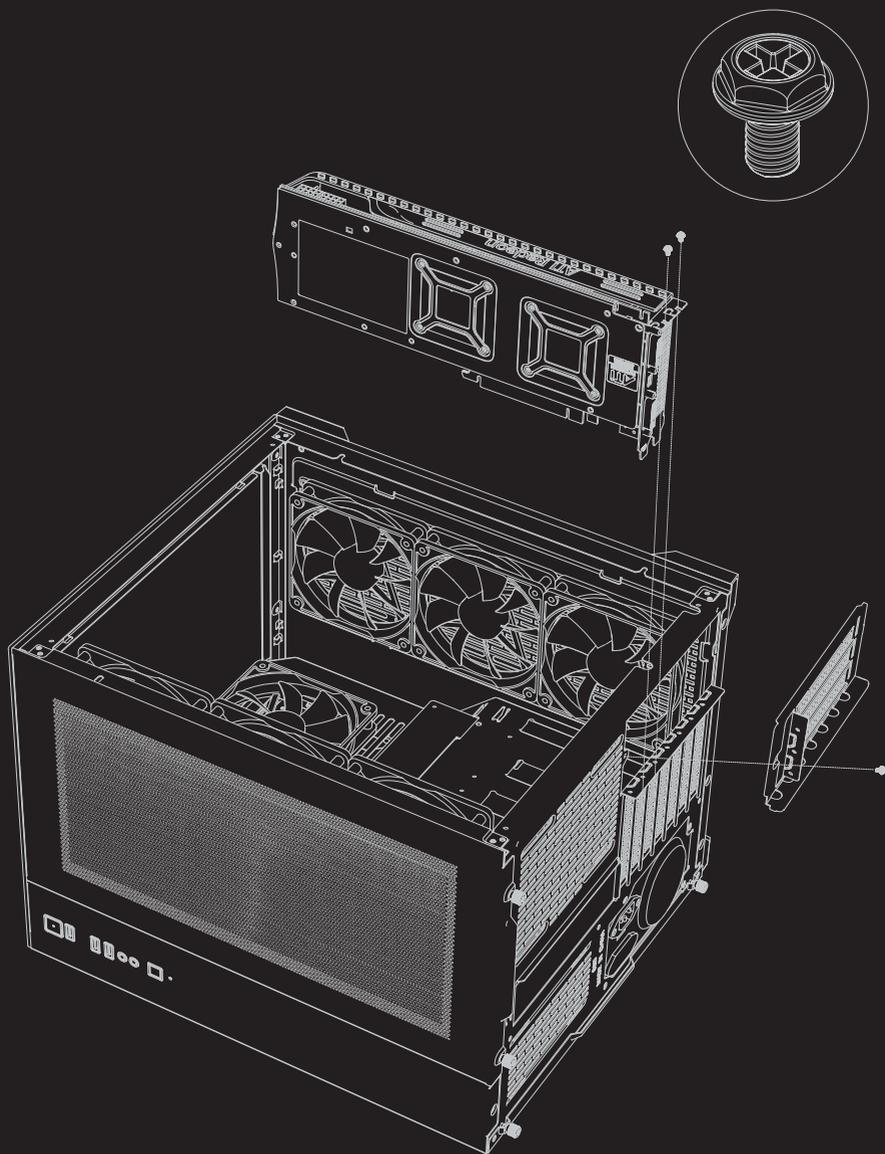
Снимите вертикальную перегородку для видеокарты (PCI-E) в соответствии с размером Вашей видеокарты и установите её с помощью винтов для блока питания в корпус
