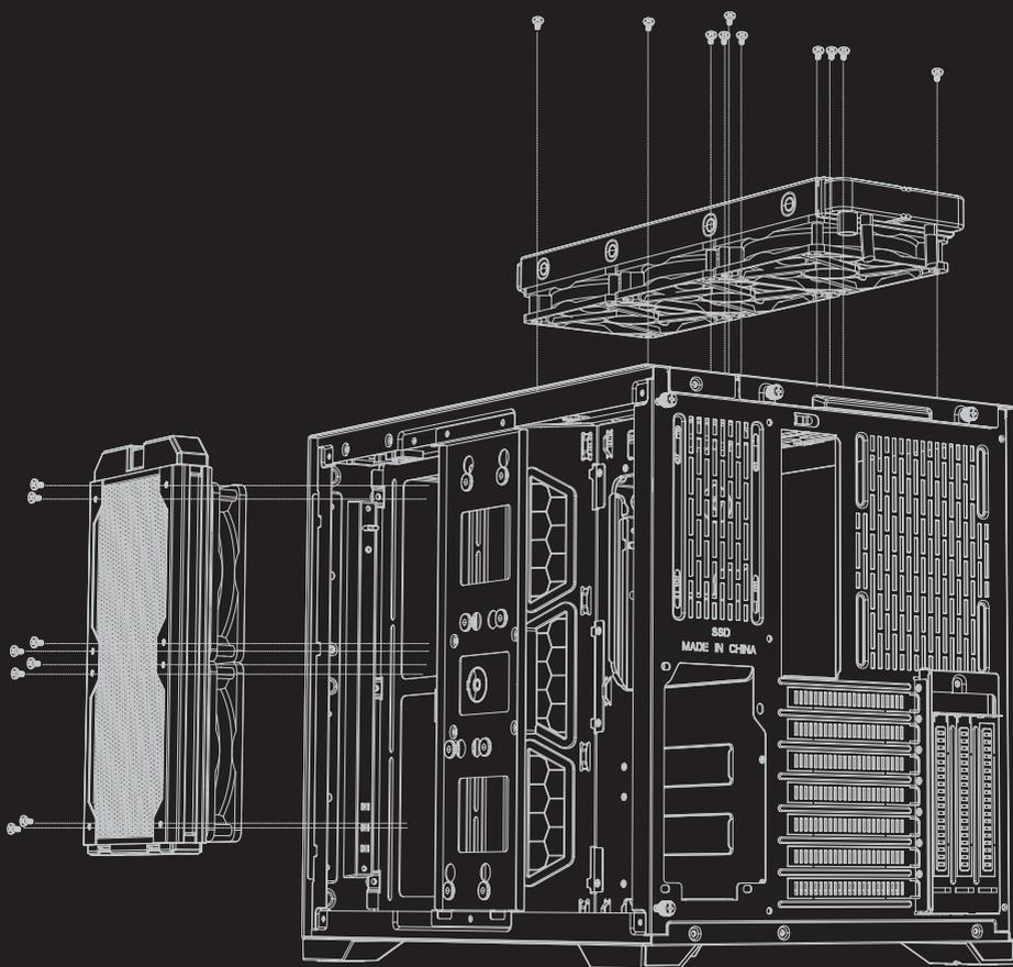
При необходимости установите водяное охлаждение на верхнюю или боковую панель корпуса
