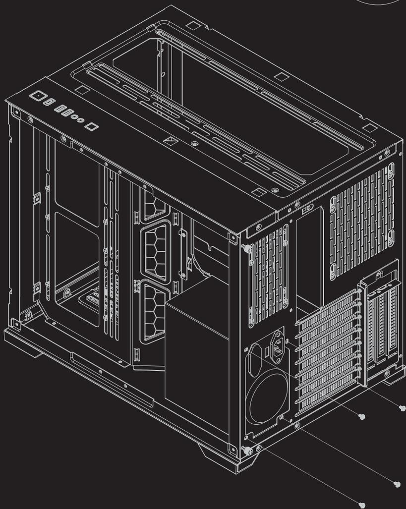
Совместив отверстия для винтов, установите блок питания в корпус и закрепите соответствующими винтами
