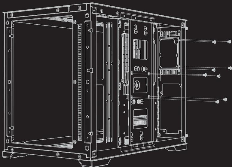
Совместите отверстия для винтов и установите диск SSD на заднюю панель корпуса с помощью винтов для материнской платы
