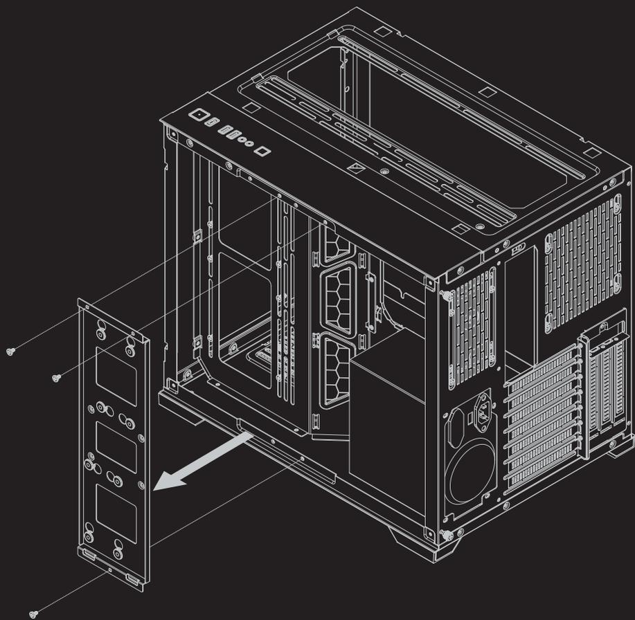
Ослабьте винты и извлеките крепление для жесткого диска из корпуса
