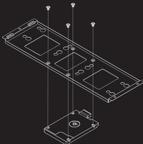
Совместите отверстия для винтов и закрепите диски SSD на крепление с помощью винтов для материнской платы
