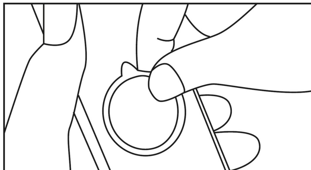
4. Внутри держателя располагается адсорбирующий материал. Через специальную воронку в держателе нанесите на него пару капель любимого ароматизатора.
