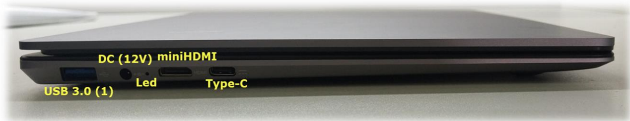
Обзор интерфейсных разъемов (левая сторона)
