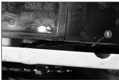
Рис. 8 Винт регулировки подачи масла
