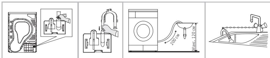
Используйте плоскогубцы, чтобы снять сливной шланг с крепления шланга.
