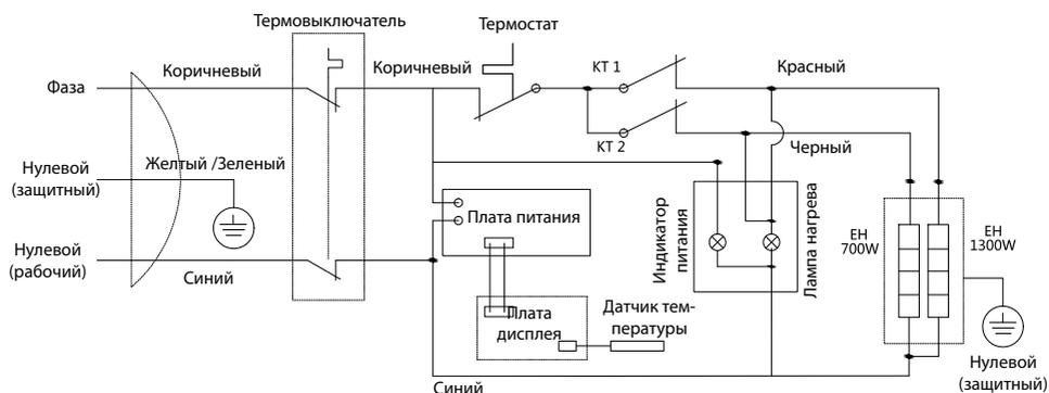
**Примечание:** для подключения электропитания к бойлеру рекомендуется провести от распределительного щита квартиры отдельный кабель сечением медной жилы не менее 2,5 мм, а сам распределительный щит обязательно оснастить прибором УЗО для защиты от поражения электрическим током в случае утечки электричества на корпус бойлера.
