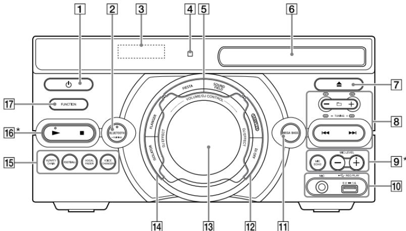
\* Кнопки **▶** и **MIC LEVEL +** имеют тактильную точку. Используйте тактильную точку в качестве ориентира при управлении системой.
