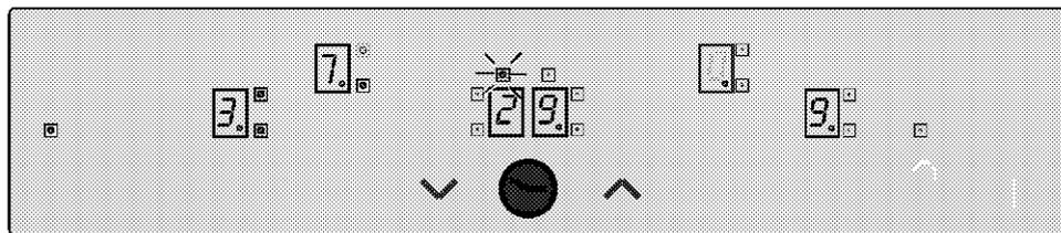
Отображение оставшегося времени на индикаторе таймера конфорки 3 (индикаторный светодиод мигает) на индикаторе таймера (Включенные светодиоды обозначают работающие таймеры конфорок 1 и 4, в настоящее время не отображенные на индикаторе таймера)
