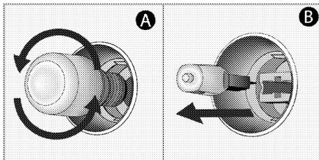
3. Если в вашей духовке используется лампа типа (А), показанная на рисунке ниже, поверните ее в соответствии с рисунком, чтобы извлечь ее и заменить. Если используется лампа типа (В), потяните и
