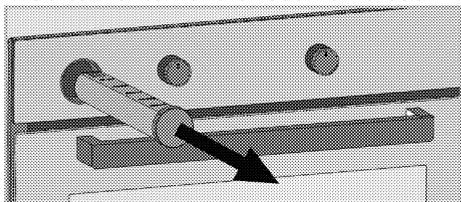
5. Ouvrez le couvercle du réservoir d'eau et remplissez-le d'eau conformément à la quantité indiquée dans le tableau de cuisson.
