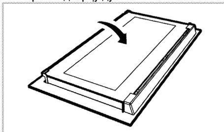
2. Потяните к себе и снимите пластмассовую накладку на верхней стороне дверцы.
