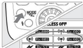
Когда YN720 работает как ведомое устройство при съемке с радиоуправлением, поддерживает быть установлена в 6 группах (A/B/C/D/E/F).
