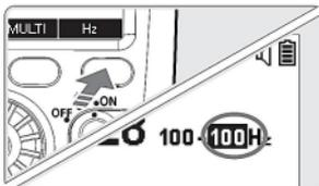
**⚠ Внимание:** При низком уровне заряда батарей скорость перезарядки становится медленной, что может привести к отсутствию вспышки при высокочастотных синхронизациях. И в этом случае, снизьте частоту вспышки или замените элементы питания.
