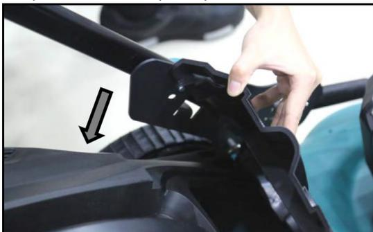
5. Для снятия контейнера для травы и установки насадки для мульчирования выполните указанные выше действия в обратном порядке.
