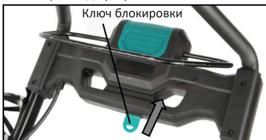
5. Чтобы извлечь аккумуляторный блок, потяните защелку крышки и откройте крышку отсека, нажмите на кнопку фиксатора на аккумуляторном блоке и извлеките его из устройства. Выньте ключ блокировки и закройте крышку отсека.
