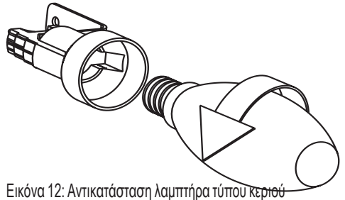
Εικόνα 12: Αντικατάσταση λαμπτήρα τύπου κεριού
