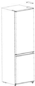
2. Открутите шурупы, фиксирующие верхнюю петлю, с помощью крестовой отвертки.
