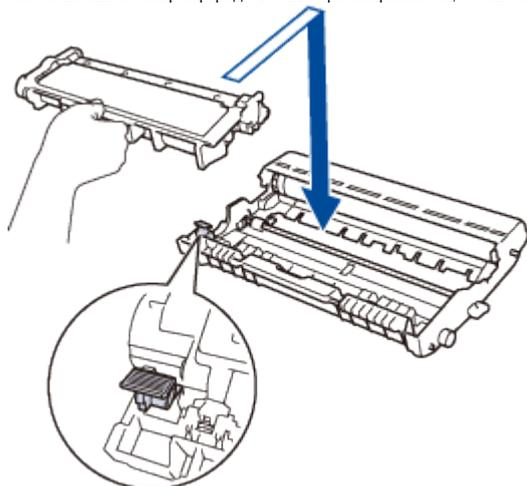
Проверьте, что тонер-картридж установлен правильно; в противном случае он может отсоединиться от фотобарабана.
