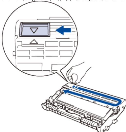
Обязательно верните ползунок в исходное положение (▲). Стрелка на лапке должна быть на одной линии со стрелкой на фотобарабане. В противном случае на напечатанных страницах может появиться вертикальная полоса.
