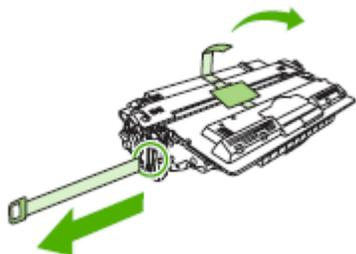
6. Совместите картридж с направляющими внутри устройства, с помощью ручки установите его до плотной посадки, а затем закройте правую переднюю дверцу.
