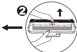
Аккуратно снимите защитную крышку в направлении, указанном на рисунке.
