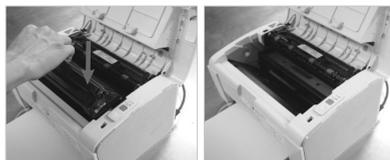
2. Достаньте новый картридж из упаковки, аккуратно встряхните его из стороны в сторону для равномерного распределения тонера внутри картриджа.
