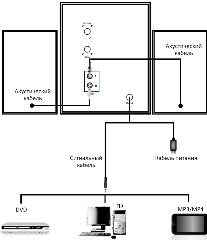
1. Подсоедините акустические кабели к соответствующим RCA-разъемам на задней панели сабвуфера.
