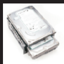
Вставьте второй HDD 3.5" в крепежный кронштейн
