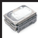
Закрепите второй HDD 3.5" при помощи винтов с обеих сторон
