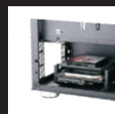
Установите крепежный кронштейн на место
