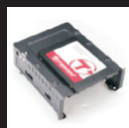
Расположение SSD в салазках HDD
