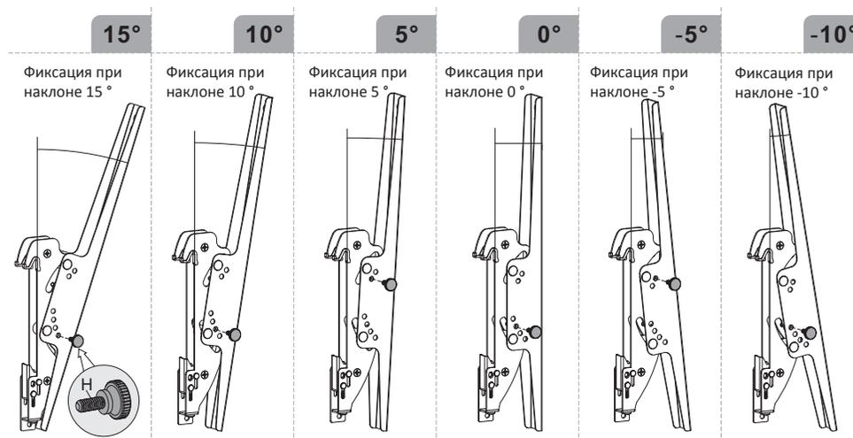
Угол наклона кронштейна от -10° до 15°, зафиксировать можно при угле наклона 15°, 10°, 5°, 0°, -5° и -10°.
