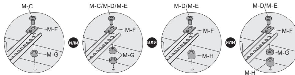
**Примечание:** выбирайте подходящие винты, шайбы и распорки (при необходимости) в соответствии с типом экрана.
