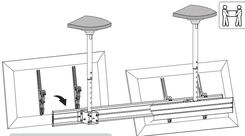
Поднимите ТВ и закрепите верхнюю часть креплений на универсальных панелях.
