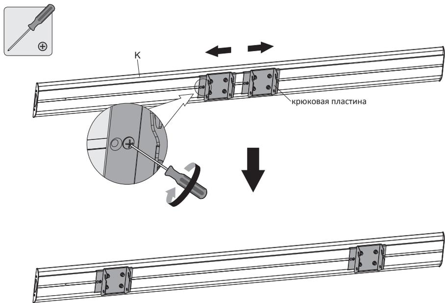
Ослабьте винты на крюковых пластинах.
