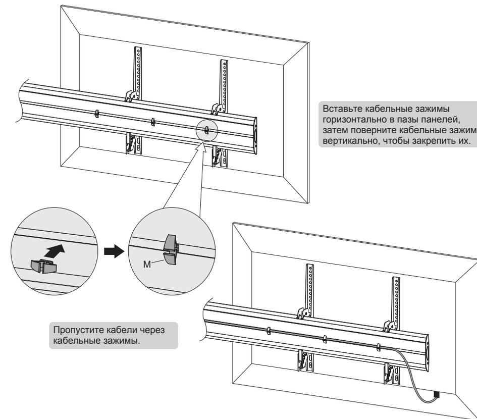
Вставьте кабельные зажимы горизонтально в пазы панелей, затем поверните кабельные зажимы вертикально, чтобы закрепить их.
