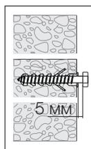
Закрутите 2 винта, оставляя 5 мм от поверхности потолка.
