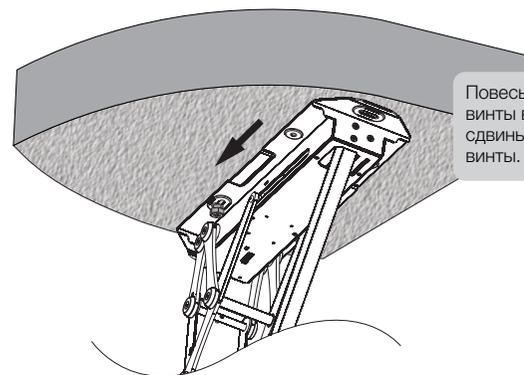
Повесьте потолочное крепление так, чтобы винты входили в отверстия. Немного сдвиньте крепление, а затем затяните винты.
