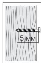
Закрутите 2 винта, оставляя 5 мм от поверхности потолка.
