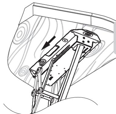
Повесьте потолочное крепление так, чтобы винты входили в отверстия. Немного сдвиньте крепление, а затем затяните винты.
