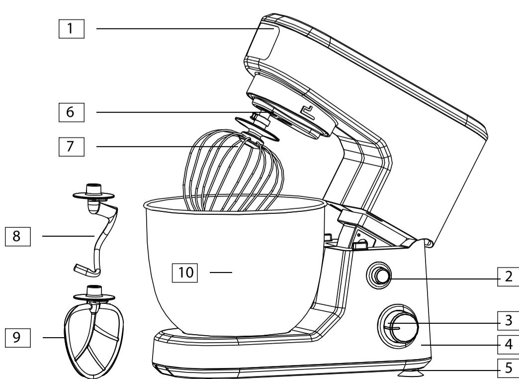
Нажмите на верхнюю откидывающуюся консоль, чтобы она опустилась и защелкнулась на месте одним щелчком. Крышка должна плотно прилегать к смесительной чаше, в противном случае она устанавливается неправильно. Теперь прибор готов к использованию.
