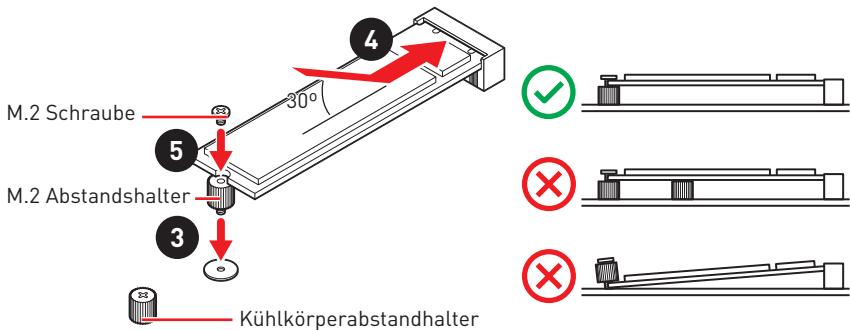
6. Setzen Sie den M.2-Kühlkörper wieder ein und sichern Sie ihn.
