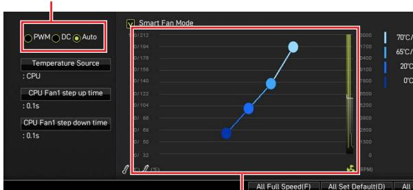
Die Gradientenpunkte des Lüfterverlaufs erlauben die Anpassung der Lüfterdrehzahl in Abhängigkeit von der CPU-Temperatur.
