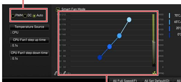
Il y a des points de gradient de la vitesse du ventilateur qui vous permet d'ajuster la vitesse de ventilateur par rapport à la température du processeur.
