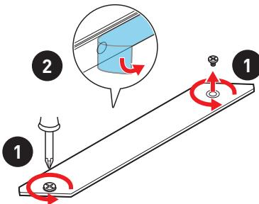
3. Entfernen Sie den M.2-Abstandhalter und befestigen Sie ihn an der entsprechenden Position Ihrer M.2-SSD. Zur Vermeidung von Schäden der M.2 SSD: Wenn die M.2-SSD dieselbe Länge wie der M.2-Steckplatz aufweist, entfernen Sie den Abstandhalter unter der M.2-SSD..
