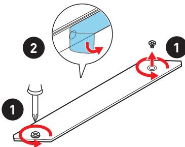
3. Закрутите стойку для крепления M.2 модуля в подходящее отверстие, в соответствии с длиной вашего M.2 SSD. Если модуль M.2 SSD и радиатор M.2 имеют одинаковую длину, во избежание повреждения модуля M.2 SSD выкрутите стойку M.2.
