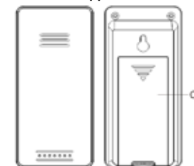
Часть С. Беспроводной выносной датчик C1: отсек для батареек
