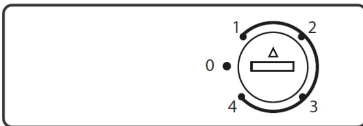
Регулятор температуры расположен в верхней части устройства.
