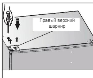
10. Вставьте заглушки в винтовые отверстия в правом углу верха холодильника. Установите крышку верхнего шарнира (в пакете) на левый угол. Другую крышку верхнего шарнира уберите в пакет.
