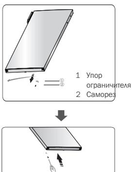
10. Положите холодильник на мягкий пенопластовый материал. Открутите саморезы с фланцами и снимите обе регулируемые ножки и нижний шарнир.
