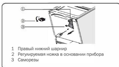
6. Переставьте нижний шарнир на левую сторону и прикрутите саморезами с фланцем. Поменяйте местами регулируемые ножки и закрепите.
