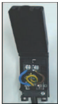
Рис. 2: Электрическое соединение кабеля прибора.
