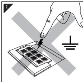
Перед работой с модулями памяти коснитесь неокрашенного и заземленного металлического объекта или воспользуйтесь заземленным антистатическим браслетом, чтобы предотвратить возникновение разряда статического электричества.
