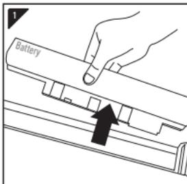
Отсоедините кабель питания и снимите батарею.
