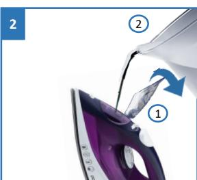
Обережно наповніть резервуар чистою, холодною водою за допомогою стаканчика
