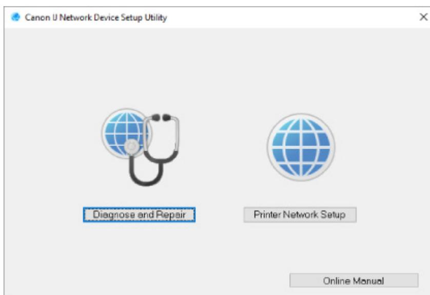
Выберите **Диагностика и исправление** или **Сетевая настройка принтера** на открывшемся экране.
