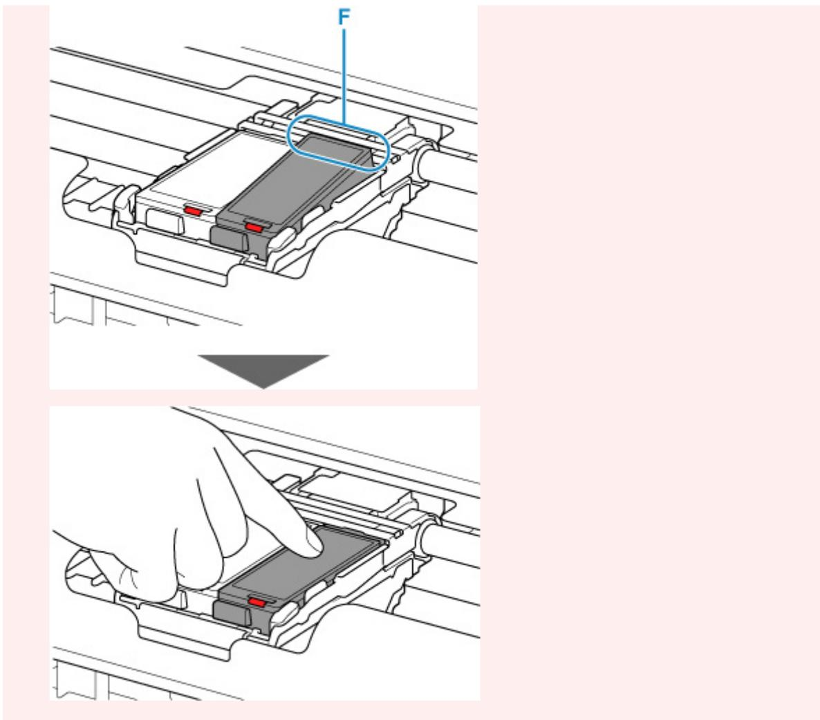
7. Закройте крышку печатающей головки.
