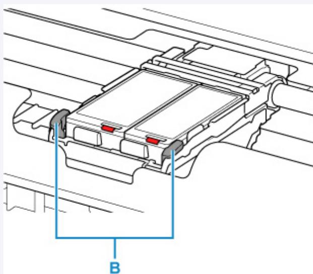
Если вы вытянули фиксирующий рычаг печатающей головки, зафиксируйте его снова.
