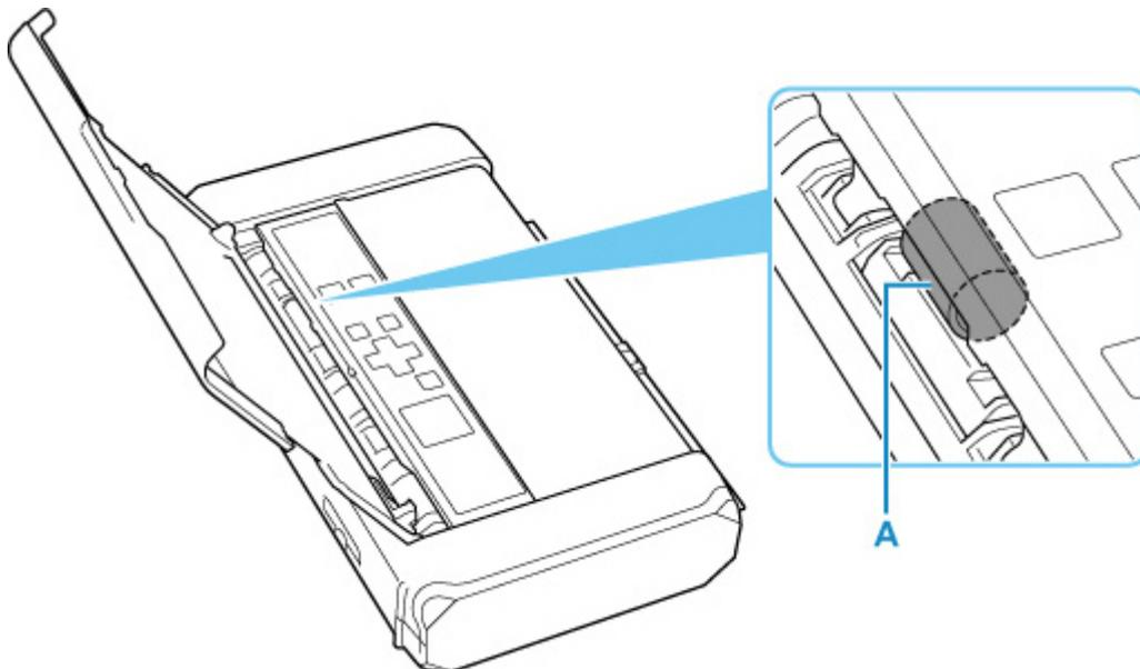
После очистки подающего ролика с помощью влажного ватного тампона включите питание, затем очистите подающий ролик еще раз.
