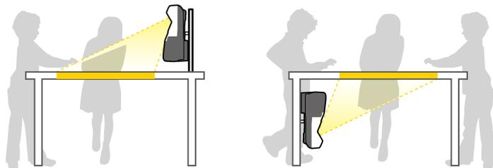
Проверьте, что выбран параметр **Проецирование** в меню **Расширен.** проектора в зависимости от используемого способа установки.
