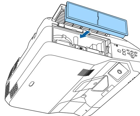
**5** Закройте крышку воздушного фильтра.
