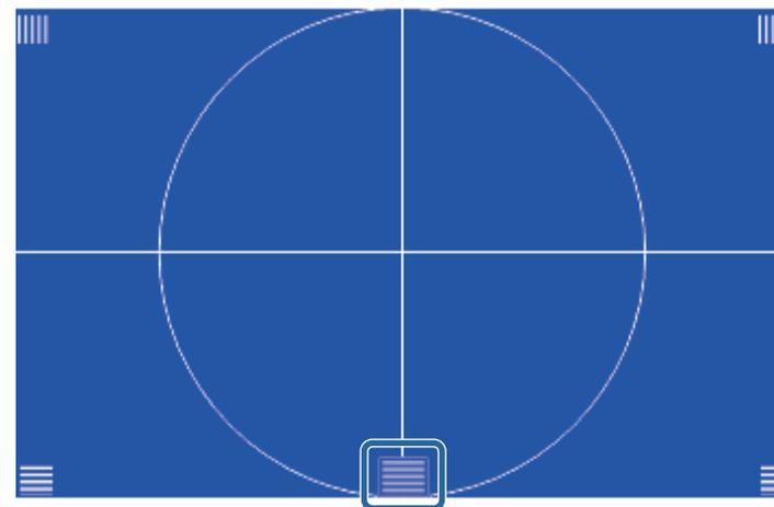
**7** Проверьте фокусировку по углам проецируемого экрана.
